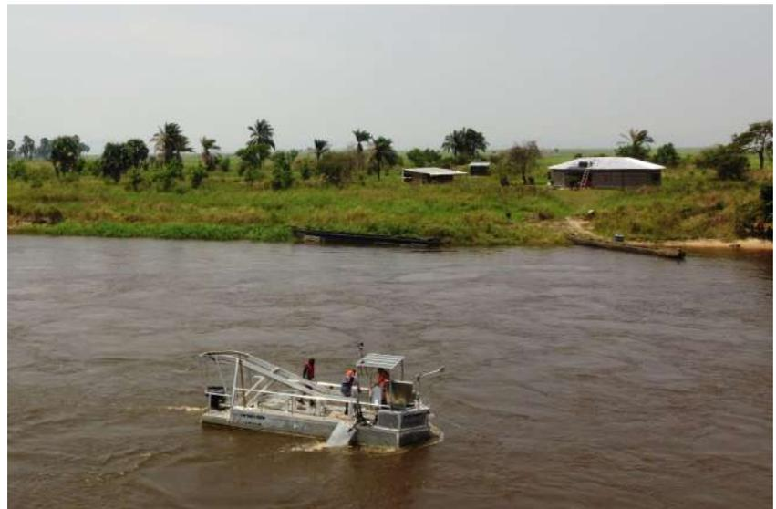
Notre solution consiste à **produire de l'électricité** grâce à une **hydrolienne flottante (Hydro-Gen)** sur le fleuve Congo, pour fournir de l'**eau potable**, permettre **stockage et transformation** agroalimentaire, **lumière**, communication, et **alimenter** des équipements pour l'artisanat et l'élevage.
